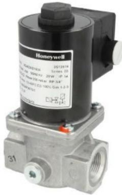
Válvula Solenoide de abertura e fechamento rápido, Classe "A" com ajuste de vazão. Para controle e regulação de queimadores a gás, para aplicações em fornos caldeiras e outros aparelhos consumidores de gás.
