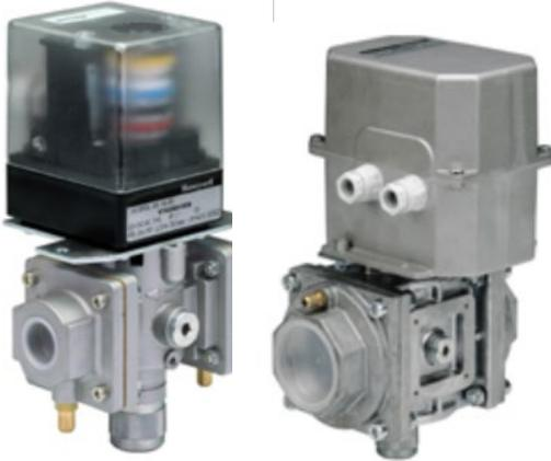
A válvula permite a modulação com fluxo mínimo, através da regulação do ângulo inicial do atuador, e o fluxo máximo através do ajuste do parafuso de regulação na parte inferior da válvula.
