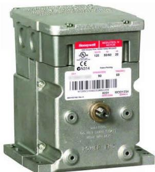
Servomotor Modutrol da Serie 90, sem retorno por mola e com controle proporcional (135 ohm), para abertura de dampers e válvulas.
