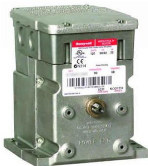
Servomotor Modutrol da Serie 61, sem retorno por mola e controle por pulso (floating), para abertura de dampers e válvulas.
