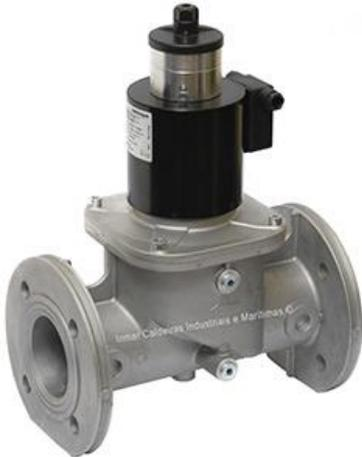
A válvula solenoide VML7-2 é uma válvula de segurança que é normalmente fechada, com abertura rápida ou lenta e seção rápida ajustável para o fluxo de gás inicial.
