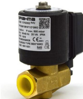
A válvula E6G\*S é uma válvula de solenoide para gás de abertura rápida, normalmente fechada, com dois tipos de orifícios 8mm e 10mm. Para aplicações comerciais e industriais, possui um filtro de malha metálica para evitar entrada de sujeira. Tensão: 220-240Vac / 50-60Hz ou 110Vac / 50-60Hz.
