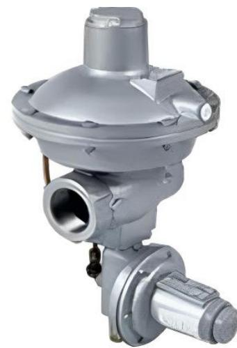
O funcionamento do sistema se dá da seguinte forma: uma pressão de saída excessiva faz com que o diafragma de bloqueio se move, liberando o mecanismo de desligamento e permitindo que o obturador interrompa o fluxo. Ele permanece nessa condição até que o reset da unidade seja realizado. Para reiniciar o sistema, é necessário liberar toda a pressão após o regulador, desrosquear o reset A e puxá-lo até que o gás comece a circular, e então rosqueá-lo novamente.
