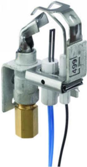
O Ignitor de Chama Q3400A substitui o conjunto da haste do dispositivo de ignição de chama original no Piloto Q3450 e Q3480 usado com o Sistema SmartValve SV9500 e SV9600.
